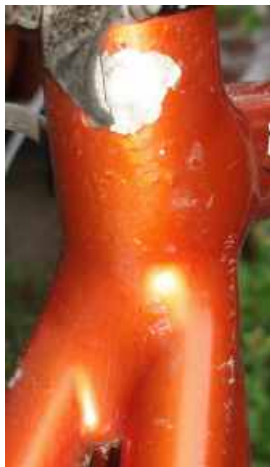
Lakschade en corrosie op ‘koperen’ fiets
